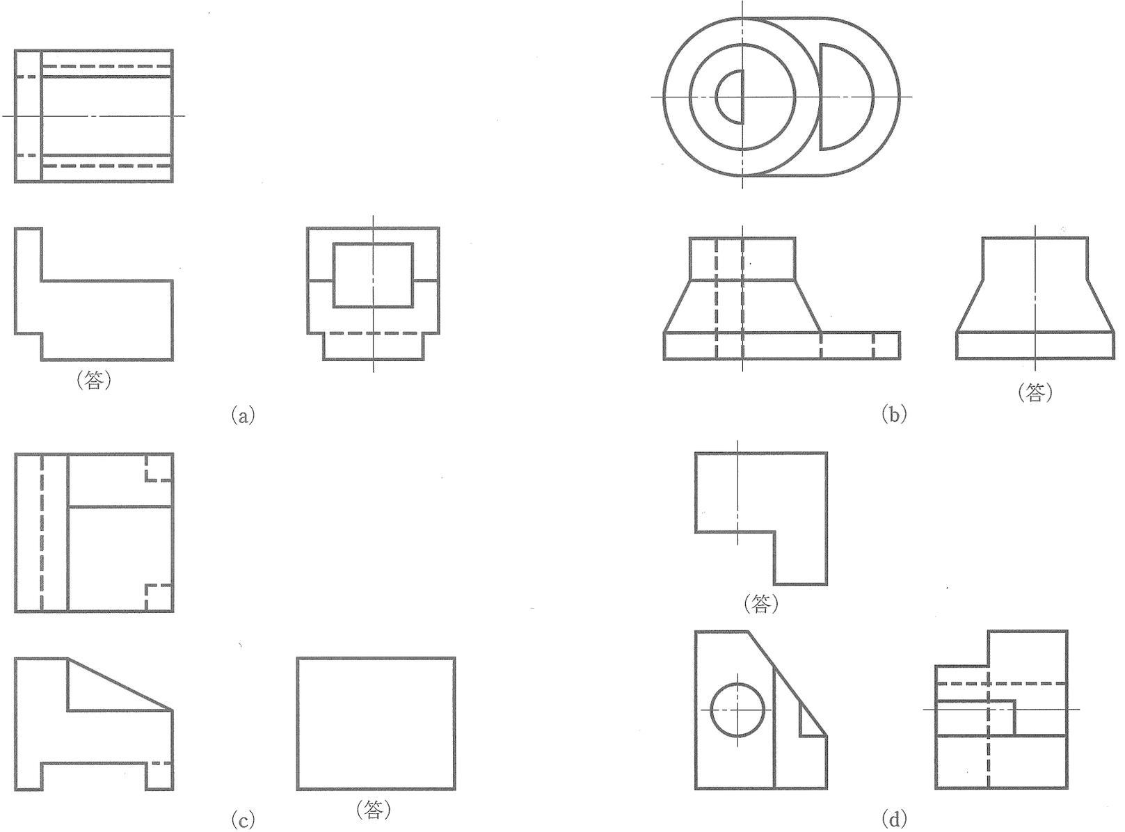
4 次の図は、ある部品の投影図である。(答)の箇所を中心線の上側で断面を、下側で外形を表しなさい(片側断面図)。また、ハッチングもほどこしなさい。
