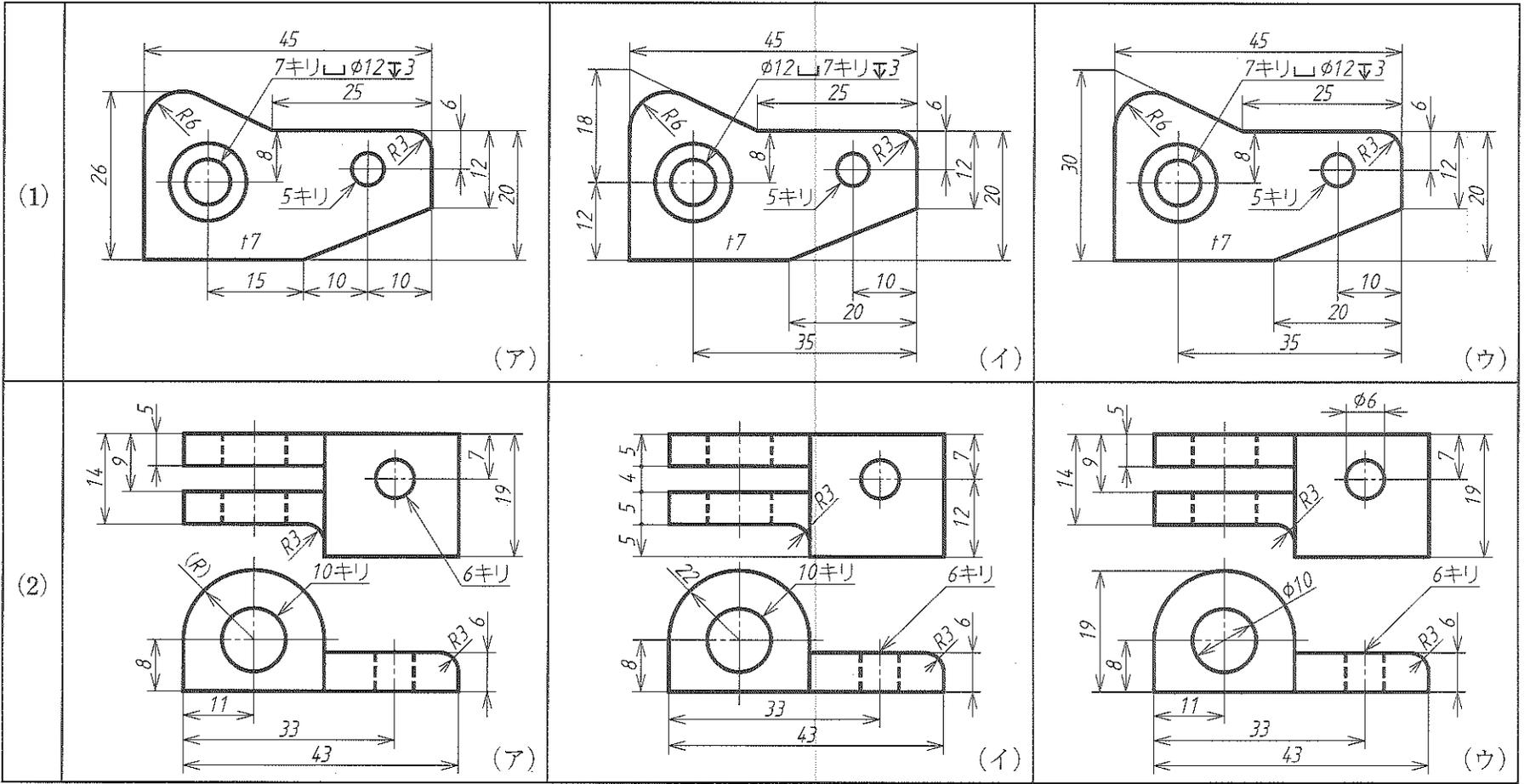
5 (1) 次の図(a), (b)で、必要でありながら記入されていない寸法がある。それを図中で測定して正しく記入しなさい。
