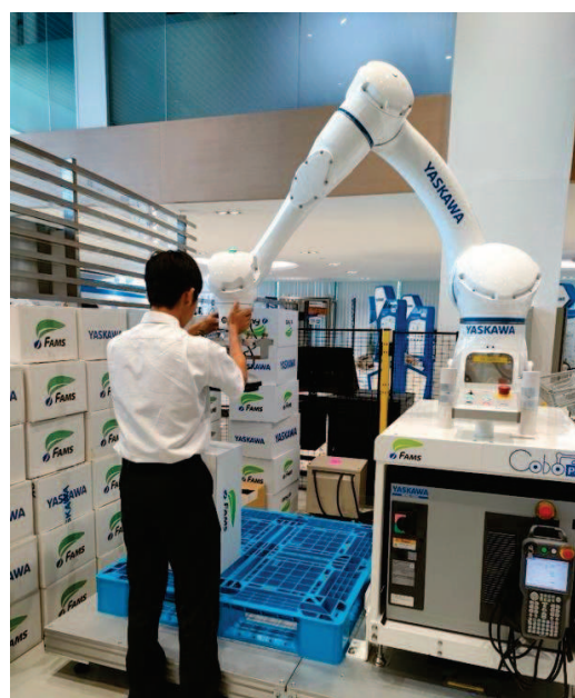
人協働ロボットを操作する様子
