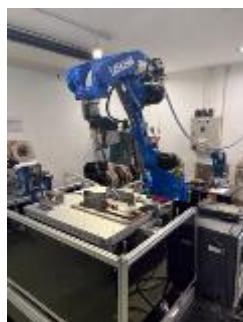
溶接ロボット
