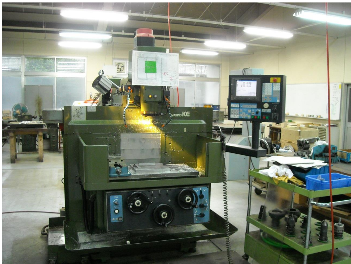
④ フライス盤外観
