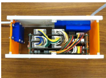
図11 EM 筐体への格納試験
