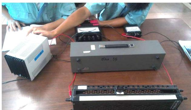
【評価：C】 測定はしやすいが、操作機器と測定器の配置が不適切である。
