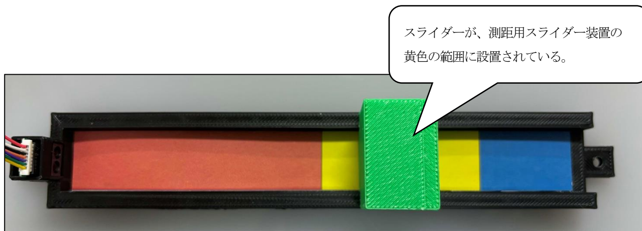
図1 測距用スライダー装置とスライダーの外観（スライダー位置が黄色の範囲）
